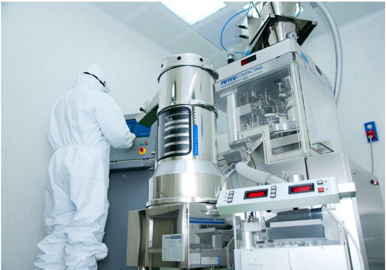
Fig. 9 - Particolare Reparto Compressione Polveri 2
