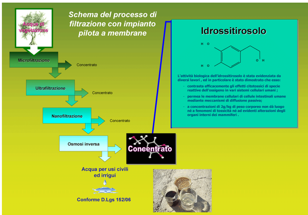
Fig. 4 - Schema del Processo di filtrazione con impianto pilota a membrane
